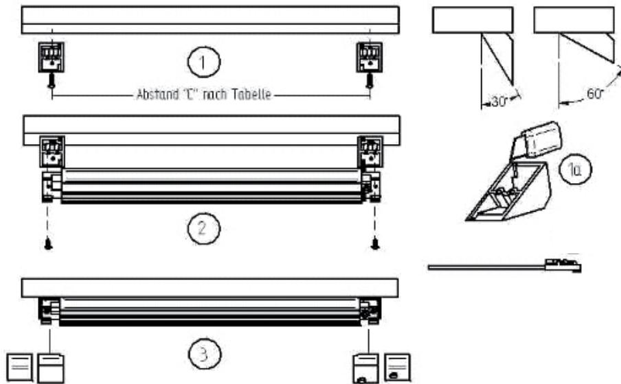
**Farbwechsler montieren: siehe Anschlußschema**
